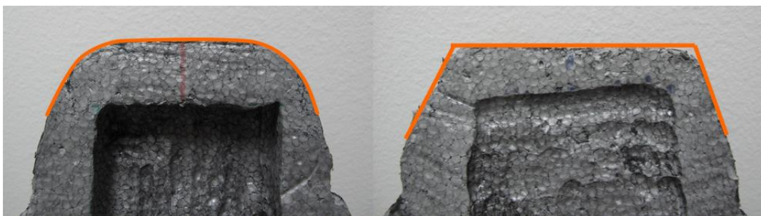
Slika 9: Preoblikovani profil sonde (levo), stari profil sonde (desno)
