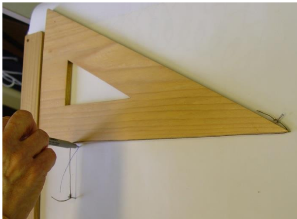
Slika 7: Doma izdelana preprosta naprava za risanje parabole.
