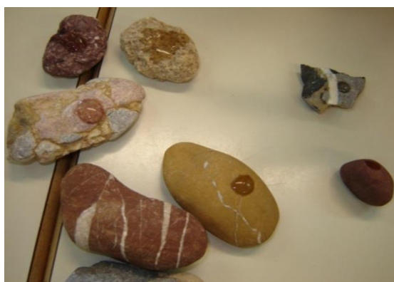
Slika 16: Na poroznem kamnu se je kaplja vode hitreje vpila v kamen.
