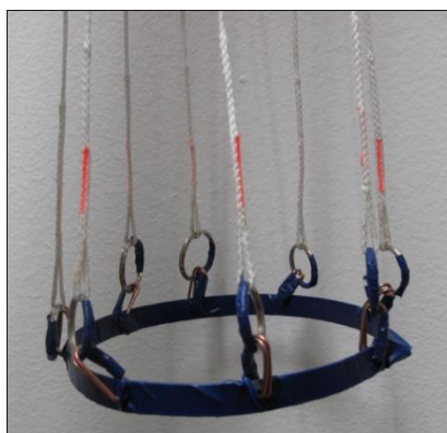
Slika 10: Izboljšava pritrditve padala na sondo.
